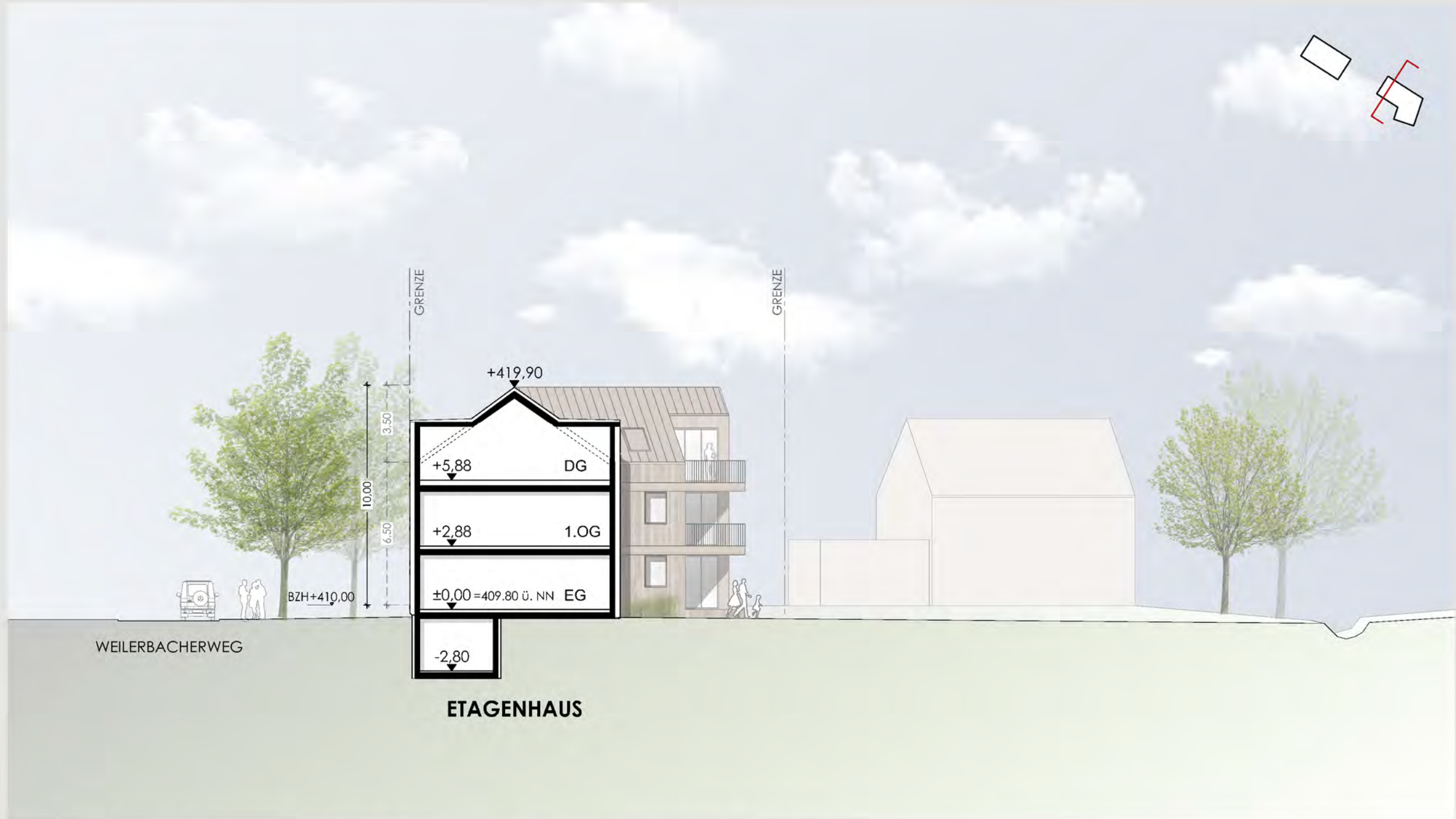
SCHNITT NORD-SÜD ETAGENHAUS M 1:200
